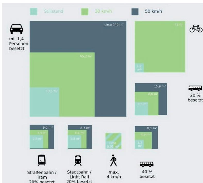
Abbildung 5: Flächenbedarf unterschiedlicher Verkehrsmittel in m<sup>2</sup>.<sup>1</sup>
